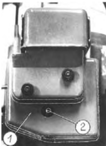
Рисунок 16 – Обогащительная кнопка карбюратора 1- крышка кожуха, 2- обогащительная кнопка
