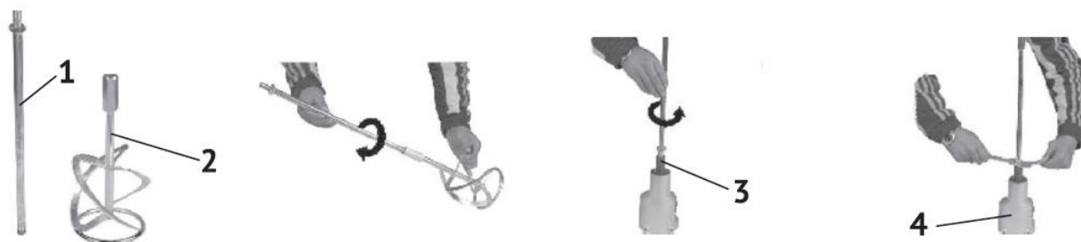
1 - удлинитель; 2 - насадка; 3 - шпindel; 4 - корпус редуктора.
