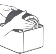
В направлении по часовой стрелке повернуть поворотную ручку выпарного барабана, как показано на изображении, чтобы снять пластину выпарного барабана
