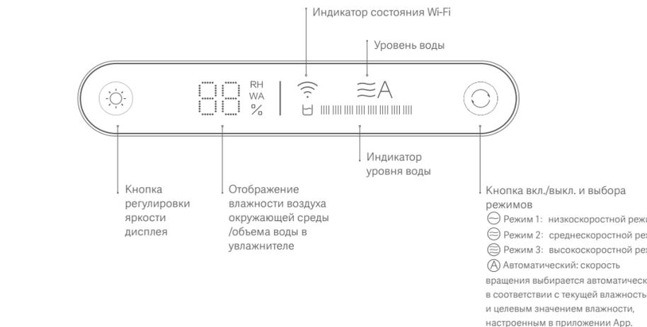
Примечание: после обнаружения того, что уровень воды достиг минимального уровня, значок уровня воды отобразится красным цветом и начнет мигать. Когда уровень воды превысит 100%, значок уровня воды загорится полностью и замигает. В процессе заливки воды на дисплее будет отображаться уровень воды в процентах, в нормальном рабочем состоянии также отображается процентное значение относительной влажности.
