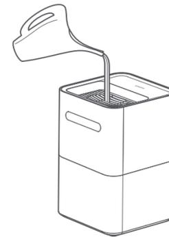
Примечание: Если уровень воды в увлажнителе превышает максимальный уровень, то при повторном включении замигает индикатор уровня воды и раздастся звуковой сигнал. В этом случае немедленно отключите увлажнитель от питания и надлежащим образом отрегулируйте уровень воды в водяном бачке.
