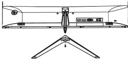
2. Прикрепите основание подставки к корпусу подставки, затянув винт.
