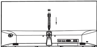
1. Положите монитор на ткань ЖК-панелью вниз, чтобы предотвратить повреждение ЖК-панели. Прикрепите винтами корпус подставки к задней части монитора.
