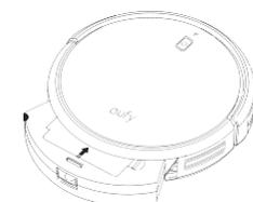
**💡** Вы можете помыть пылесборник, предварительный фильтр и пенный фильтр водой. Убедитесь, что они хорошо высохли, прежде чем вставлять их назад. Не мойте водой высокоэффективный фильтр, т.к. это может повредить его и снизить мощность всасывания.
