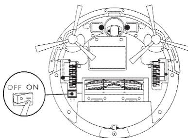
💡 Удалите наклейку возле выключателя и пенопластовые блоки возле амортизатора перед использованием.
