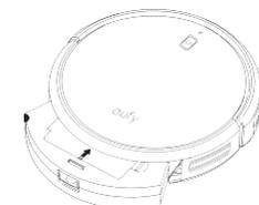
**💡** Вы можете помыть пылесборник, предварительный фильтр и пенный фильтр водой. Убедитесь, что они хорошо высохли, прежде чем вставлять их назад. Не мойте водой высокоэффективный фильтр, т.к. это может повредить его и снизить мощность всасывания.
