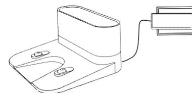
💡 Установите зарядную базу в таком месте, которое было бы легкодоступно для RoboVac. Рекомендуется размещать зарядную базу напротив стены на твердой ровной поверхности, а не на коврах или дорожках.
