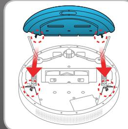
**RU** Закрепите насадку для влажной уборки на пылесосе с помощью двух специальных отверстий.
