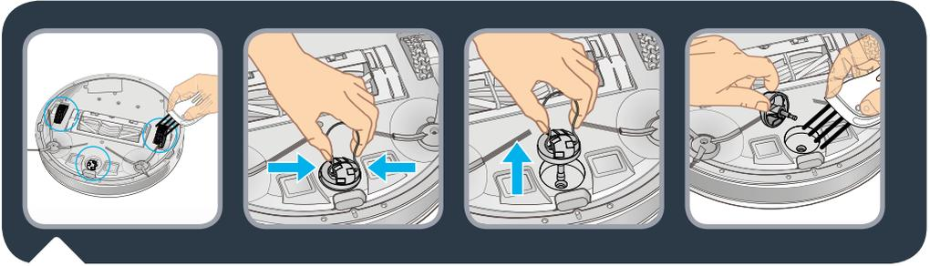
**RU** Очищайте колеса робота один раз в неделю. На вал колеса могут наматываться волосы, нити. Чтобы извлечь переднее колесо, воспользуйтесь инструментом в комплекте.
