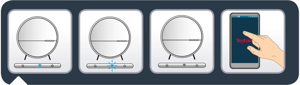
**RU** Светодиодный индикатор Wi-Fi показывает состояние подключения: индикатор горит синим цветом — робот подключен, мигает синим — робот пытается подключиться, не горит — робот отключен.
