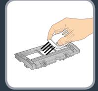
**RU** Чтобы очистить центральную щетку, сдвиньте защелки в сторону центра и поднимите крышку. Возьмитесь за центральную щетку и извлеките ее. Очистите компоненты с помощью специальной щетки. Регулярно удаляйте с центральной щетки волосы и другие запутавшиеся предметы.
