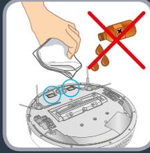
**RU** Чтобы очистить контактные пластины, откройте откидывающуюся крышку и отключите робот с помощью выключателя (или отключите шнур питания). Протрите пластины сухой тканью. Не протирайте пластины веществами, имеющими в своем составе масло. Очищайте контактные пластины один раз в месяц.
