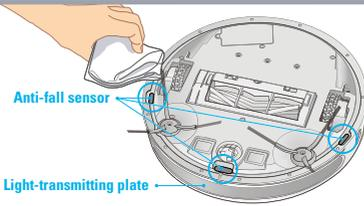
**RU** После каждого применения рекомендуется аккуратно протирать сухой хлопковой тканью прозрачную пластину и датчик во избежание скопления пыли, что может повлиять на работу прибора.
