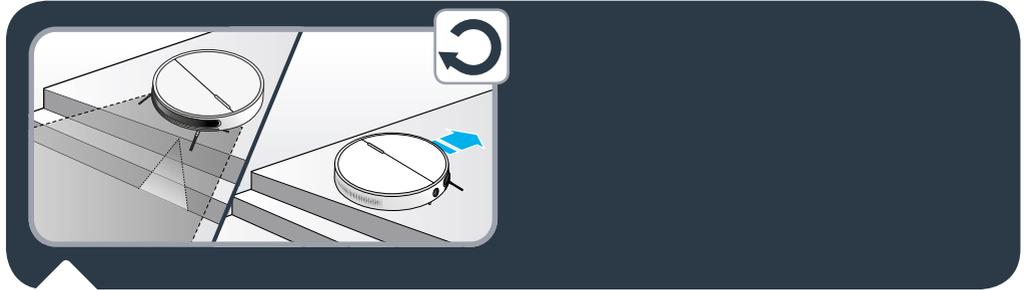
**RU** Робот оснащен датчиками падения для распознавания лестниц и обрывов. Чтобы робот правильно распознавал неровности уровня пола, убедитесь, что на полу рядом с лестницами, ступенями или обрывами отсутствуют какие-либо предметы (сумки, обувь и т. д.). Лестницы, ступени и обрывы корректно распознаются датчиками на расстоянии не менее 10 см.
