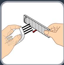
**RU** Чтобы очистить мусоросборник, откройте откидывающуюся крышку и вытащите контейнер за ручку. Снимите крышку с левой стороны контейнера, поднимите ленту сетчатого фильтра и извлеките фильтр. Выбросьте мусор, очистите мусоросборник специальной щеткой и прополощите под струей воды. Очистите фильтр с помощью щетки. Очищайте контейнер для пыли один раз в месяц.
