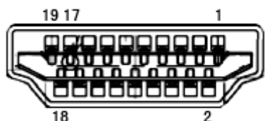
19-контактный кабель для передачи сигналов цветного изображения
