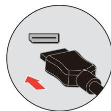
4. Для компьютера с разъемом HDMI.
