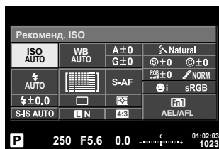
Панель управления Super control panel
