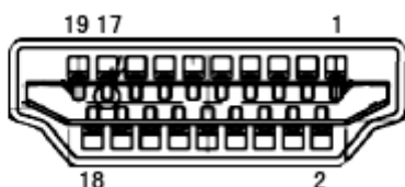
19-контактный кабель для передачи сигналов цветного изображения
