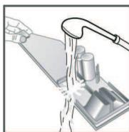
5. Емкость и крышку протрите мягкой, влажной тканью или промойте с помощью ручного душа. Внутренние поверхности протрите также мягкой, влажной тканью.
