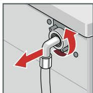
Снимите шланг со спинки прибора.
