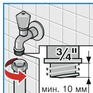
на водопроводном кране ( $3/4'' = 26,4 \text{ мм}$ ):
