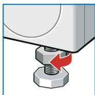
1. Отвинтите контргайку по часовой стрелке с помощью гаечного ключа.
