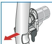
2. Извлеките шланги из колен для фиксации и снимите колена.
