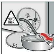
4. Снимите крышку, слейте моющий раствор в соответствующую емкость.
