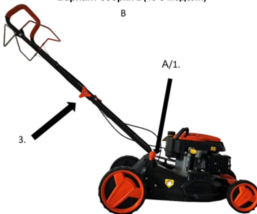
Достаньте газонокосилку из упаковки. Вставьте нижний лонжерон (А) в корпус и закрепите его с правой и левой стороны винтами. Вставьте верхний лонжерон (В) и затяните оранжевым болтом барашком, затем затяните винты и гайки с обеих сторон.
