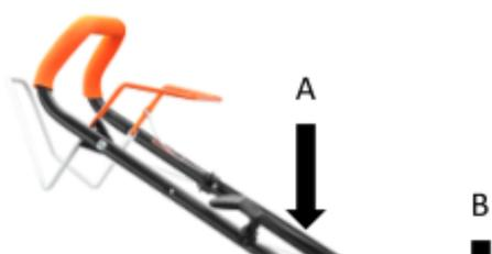
Достаньте газонокосилку из упаковки. Соедините нижнюю часть рукоятки управления (B) с корпусом газонокосилки с помощью элементов крепления (2). Затем соедините верхний лонжерон (A) с собранным нижним лонжероном (B) с помощью оранжевых болтов барашков (1).
