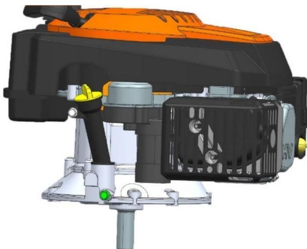
Заглушите двигатель и дайте ему полностью остановиться. Отсоедините кабель свечи зажигания, держите его вдали от свечи зажигания. Слейте масло в подходящий контейнер. Наклоните газонокосилку на 45 градусов и используйте всасывающий насос FUXTEC для всасывания масла через заливную горловину. Кроме того, вы можете наклонить газонокосилку еще больше, чтобы слить масло напрямую через горловину.
