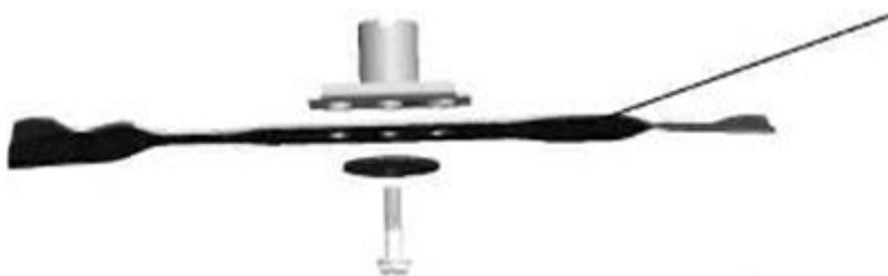
Зафиксируйте новый нож винтом, крутящий момент составляет 45 Нм. Кроме того, при замене лезвия замените и сам винт, для дополнительной безопасности.
