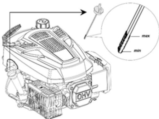
Газонокосилка поставляется без заливки 4-тактным маслом, обязательно заправьте его перед эксплуатацией.
