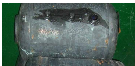
Три сварных шва на баках других производителей
