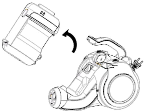
3. Держа пылесборник за круглый держатель, расположите его над мусорным баком. Надавите на защелки открывания нижней крышки пылесборника для очистки от пыли (см. рис. 3).
