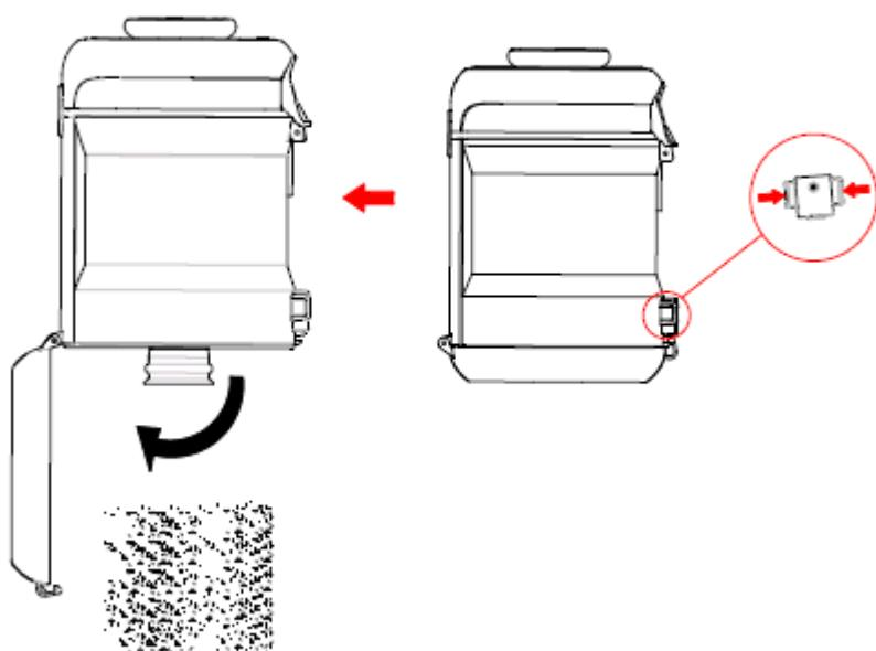
4. Нажмите на изображение стрелки на фиксаторе верхней крышки пылесборника. Откройте верхнюю крышку. Извлеките входной фильтр. Вытряхните его, слегка постукивая о твердую опору. Извлеките из пылесборника узел циклонного фильтра в сборе. Промойте холодной проточной водой пылесборник и узел циклонного фильтра. При необходимости также промойте входной фильтр под холодной проточной водой. Не используйте мыло и моющие средства!
