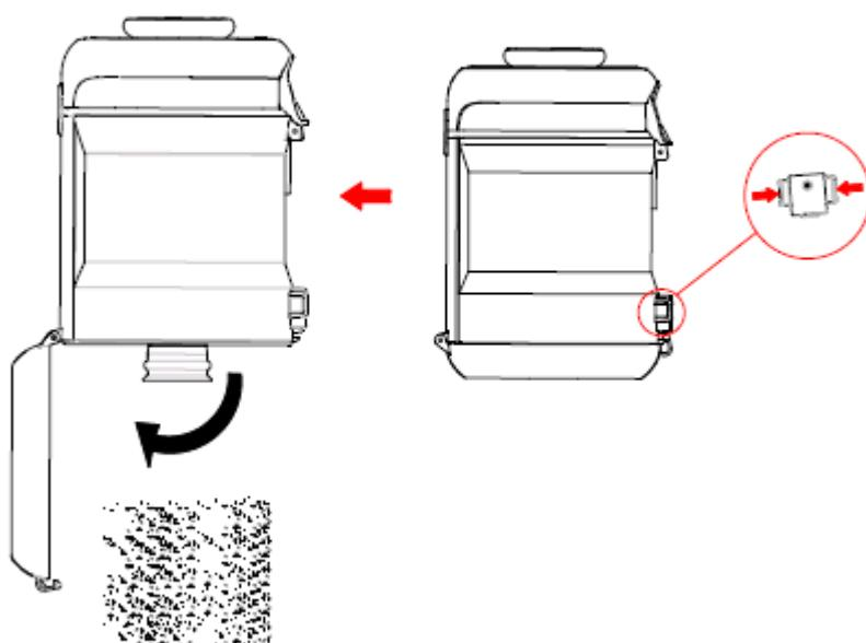
9. Apăsați pe săgeata de pe zăvorul de pe capacul superior al recipientului pentru praf. Deschideți capacul superior. Extrageți filtrul de intrare. Agitați-l atingând ușor un suport solid. Scoateți ansamblul filtrului ciclonic din colectorul de praf. Clătiți colectorul de praf și filtrul ciclonic cu apă curentă rece. Dacă este necesar, clătiți filtrul sub jet de apă rece. Nu folosiți săpun și detergenți!
