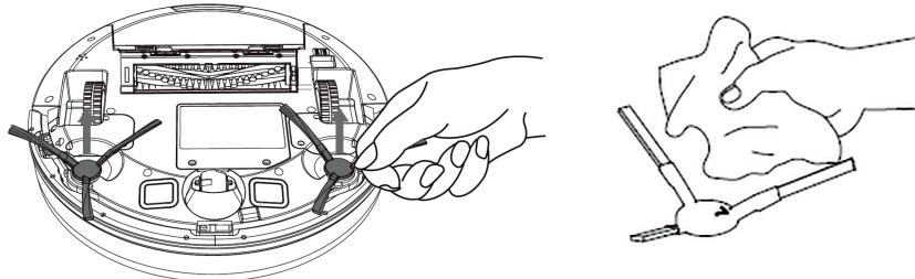
2. После очистки боковых щеток установите их обратно и прижмите к корпусу пылесоса до щелчка. Щетку с обозначением «L» установите на посадочное место с подписью «L», а щетку с обозначением «R» — на посадочное место с подписью «R». Щетки различаются направлением изгиба ворса, поэтому не путайте их.
