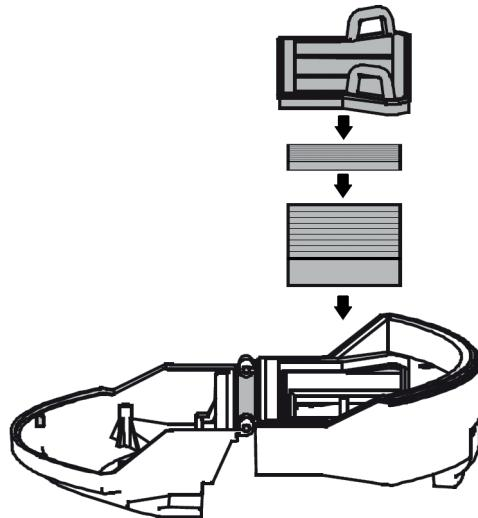
8. Закройте крышку пылесборника до щелчка, а затем установите пылесборник обратно в корпус пылесоса.
