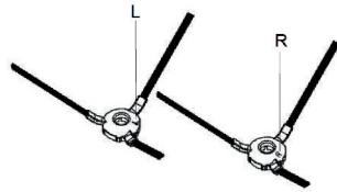
Для установки каждой щетки наденьте ее на ось и прижмите к корпусу пылесоса до щелчка. После установки проверьте, врачаются ли щетки.
