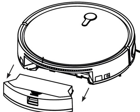
2. Если во время влажной уборки в отсеке для сбора пыли скопилась пыль, вы тряхните ее из моющего модуля и протрите отсек сначала влажной, а затем сухой тканью.
