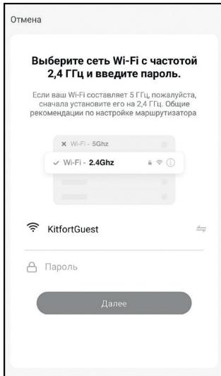
**Примечание.** Робот-пылесос работает на частоте 2,4 ГГц. Если ваш роутер поддерживает частоту 5 ГГц, то робот-пылесос может плохо находить соединение по сети Wi-Fi. Чтобы устранить эту проблему, отключите сеть 5 ГГц на роутере или переименуйте ее:
