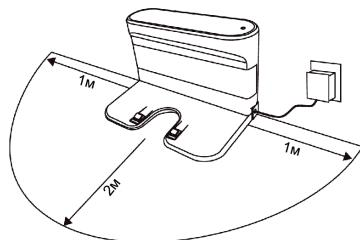
Пылесос может плохо находить базу из-за большого количества зеркал, металлических поверхностей или из-за расположения базы под прямыми солнечными лучами.
