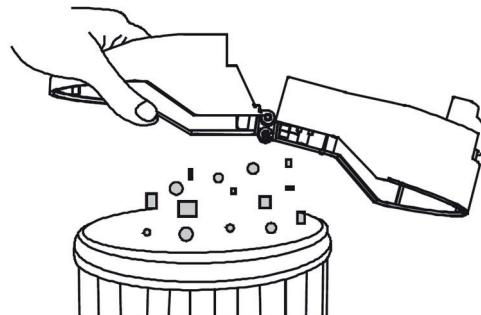
5. Очистите фильтры. При несильном загрязнении рекомендуется механически вытряхивать мусор из фильтров. При сильном загрязнении допускается промывка фильтров под проточной водой. При промывке фильтра тонкой очистки запрещается использовать щетки, поскольку фильтр состоит из целлюлозы и может повредиться от механических воздействий. Фильтр грубой очистки можно очищать щеточкой для очистки, идущей в комплекте. Поролоновый фильтр можно промывать теплой мыльной водой.
