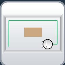
**RU** Для уборки вдоль стен и в углах воспользуйтесь режимом «Вдоль стен». Нажмите три раза на кнопку питания — робот начнет уборку, а кнопка питания будет гореть синим цветом.
