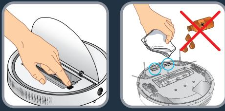
**RU** Чтобы очистить контактные пластины, откройте откидывающуюся крышку и отключите робот с помощью выключателя (или отключите шнур питания). Протрите пластины сухой тканью. Не протирайте пластины веществами, имеющими в своем составе масло. Очищайте контактные пластины один раз в месяц.
