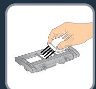
**RU** Чтобы очистить центральную щетку, сдвиньте защелки в сторону центра и поднимите крышку. Возьмитесь за центральную щетку и извлеките ее. Очистите компоненты с помощью специальной щетки. Регулярно удаляйте с центральной щетки волосы и другие запутавшиеся предметы.
