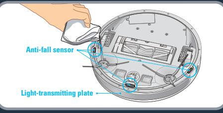
**RU** После каждого применения рекомендуется аккуратно протирать сухой хлопковой тканью прозрачную пластину и датчик во избежание скопления пыли, что может повлиять на работу прибора.
