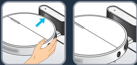
**RU** Чтобы зарядить робот, нажмите и удерживайте кнопку включения в течение 3 секунд. Поместите робот на зарядную станцию так, чтобы его контактные пластины касались клемм на зарядной станции.
