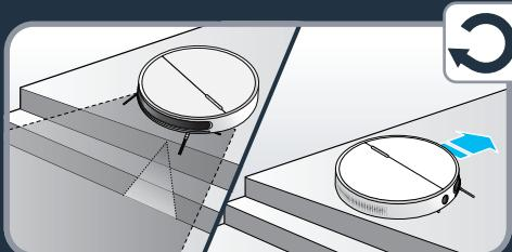
**RU** Робот оснащен датчиками падения для распознавания лестниц и обрывов. Чтобы робот правильно распознавал неровности уровня пола, убедитесь, что на полу рядом с лестницами, ступенями или обрывами отсутствуют какие-либо предметы (сумки, обувь и т. д.). Лестницы, ступени и обрывы корректно распознаются датчиками на расстоянии не менее 10 см.
