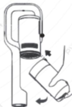
**Разберите компоненты пылесборника:** переверните пылесборник, снимите фильтрующий элемент, потяните ручку сборки вверх.
