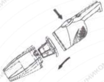
Откройте пылесборник, извлеките фильтр, промойте его водой и высушите.
