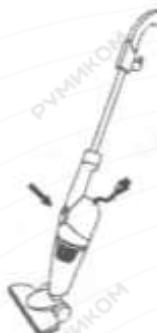
5. Для выключения устройства установите переключатель в положение О (OFF)
