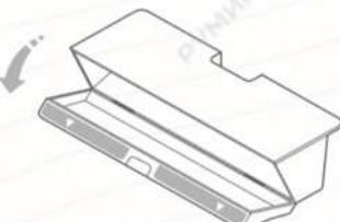
2. Промойте пылесборник, наполнив его водой и встряхнув.
