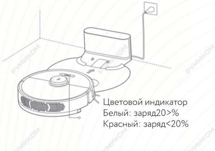
Удерживайте кнопку включения для запуска устройства, после поместите робот-пылесос на зарядную станцию. Высокопроизводительная литий-ионная аккумуляторная батарея внутри должна регулярно заряжаться для поддержания оптимальной производительности батареи.
